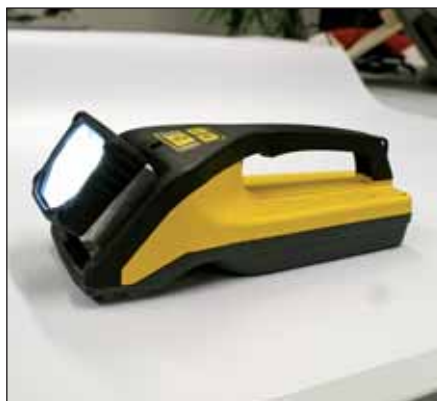
Die neue Akkuhandleuchte FlashLED mit Notlichtfunktion punktet vor allem mit ihrem vertikal schwenkbaren Beleuchtungskopf. Außerdem verfügt sie über drei wählbare Betriebsarten: 1. Weitstrahler, 2. Arbeitslicht und 3. Standlicht. Dank LED-Technik ist die Licht-Qualität ausgezeichnet
